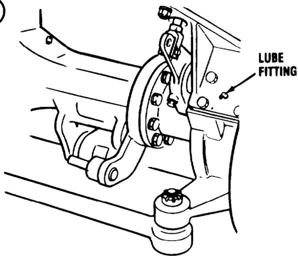
**NO. 2 AXLE SLACK ADJUSTER AND BRAKE CAMSHAFT**
