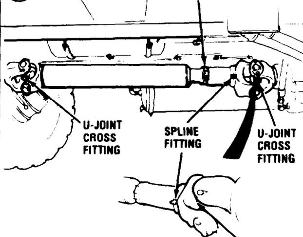
**TYPICAL PROPELLER SHAFT**
