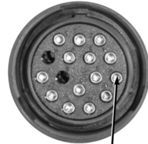
TERMINAL P WIRE 2075
